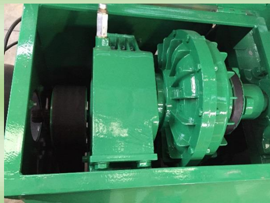
Hydrauliczne sprzęgło rozruchowe ułatwiające start i zabezpieczające przed gwałtownym zatrzymaniem.
