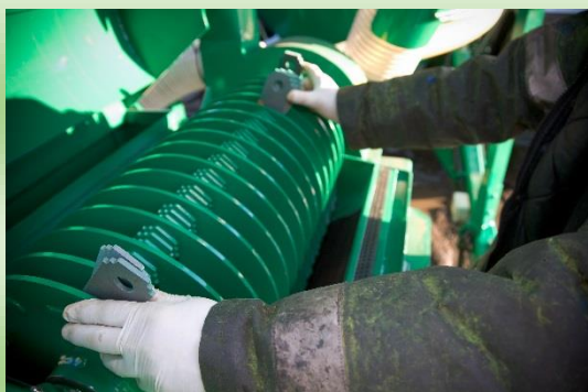
120 młotkowy młyn z młotkami 4-stronnego użytku, sita o rozmiarze od 1,5 mm do 20 mm.
