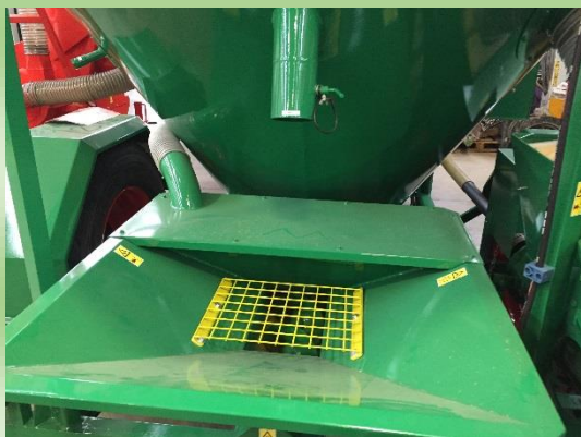
Tylny kosz zasypowy na składniki paszowe i premixy. Wysyp do oceny stopnia wymieszania paszy.
