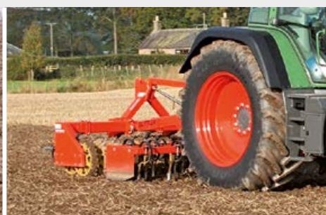
DX 30-56 z przystawką zębata i wieżą trzypunktową do zaczepienia z tyłu do uprawy przedsiewnej
