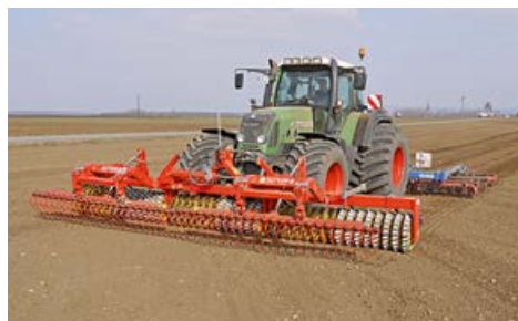
Avant SX 610-56 U z broną wyrównującą do uprawy przedsięwnej
