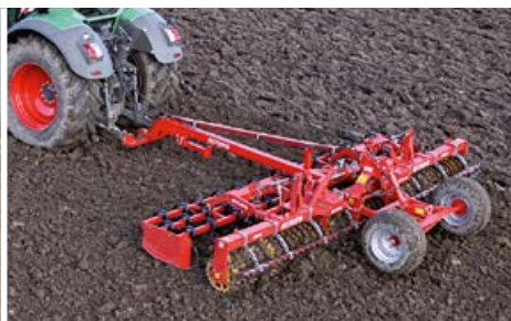
Avant SX 610-56 U z przystawką, dyszlem ciągnącym i kratownicą (również do późniejszego montażu)
