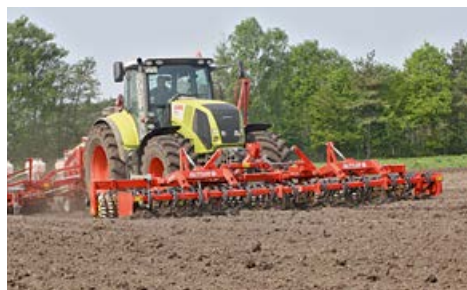
Avant SX 610-56 U z przystawką zębatą do siewu kukurydzy
