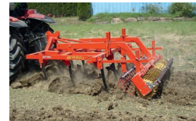
Grudy „robimy sobie sami”. Dlatego Grubber potrzebuje ciężkiego wału do ich rozdrabniania, wyrównania i ponownego zagęszczenia.
