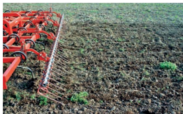
Zęby Super Maxx® wyciągają rośliny. Brona odkłada je na powierzchni, gdzie wysychają.
