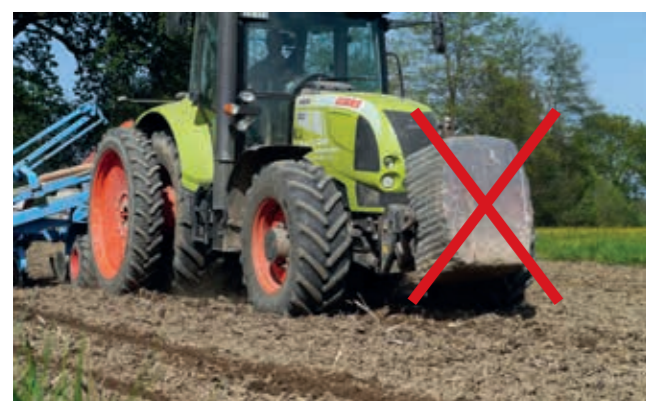
Martwy balast z przodu – przesunięcie środka ciężkości na przód: Zagęszczanie ziemi pod kołami spowodowane dużym obciążeniem osi.
