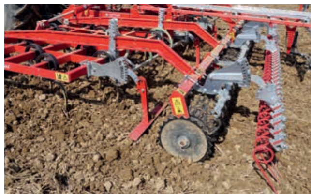
Opcjonalnie: Brona za wałem do mechanicznego zwalczania chwastów.
