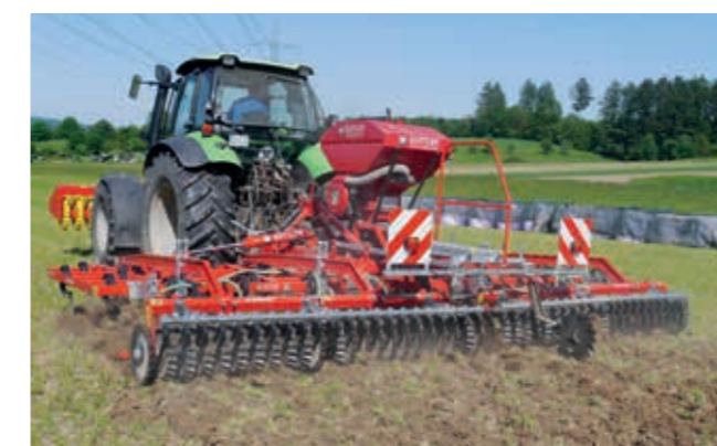
Wibrujące zęby pracują w twardej ziemi jak młot pneumatyczny.
