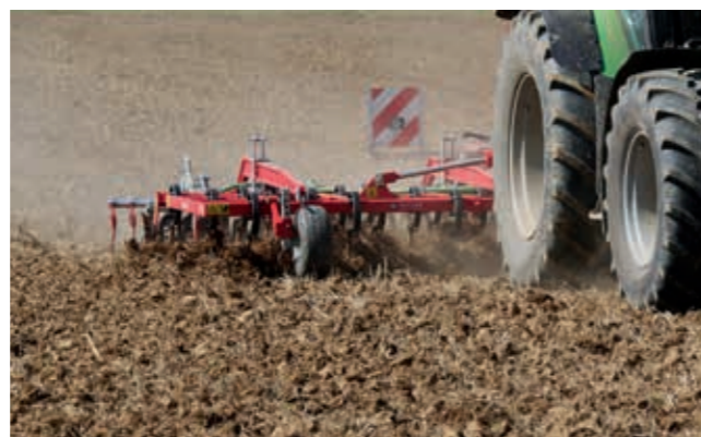
Koła podporowe z przodu, pozwalają odciążyć wał RollFix, co jest pomocne w zwalczaniu chwastów.
