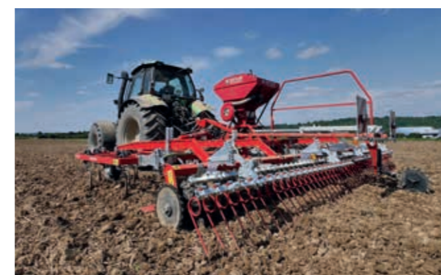
Na wilgotnej ziemi zmniejsza się nacisk na wał RollFix, przy pomocy opcjonalnych kół podporowych. Zachowawcza uprawa!
