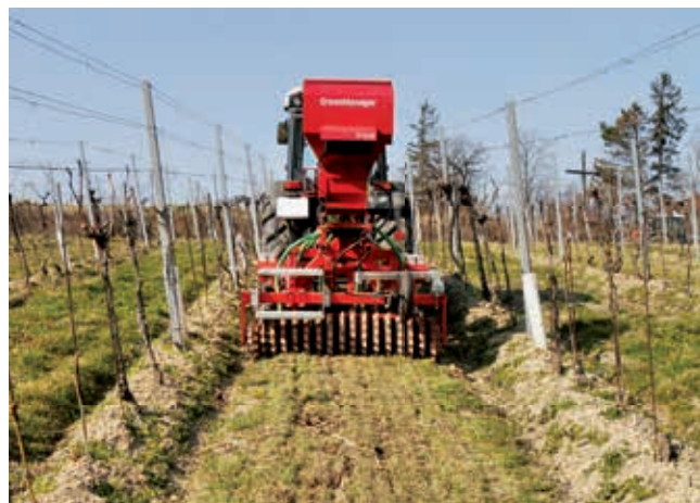
Przejazd grubberem bez mieszania ziemi. Ziemia pozostaje przykryta: zapobieganie erozji, oszczędność wody.
