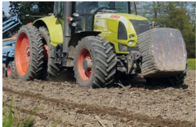
Schlepper mit Frontgewicht – So vergeudet man Energie. Außerdem schädigt man den Boden und die Kultur.
